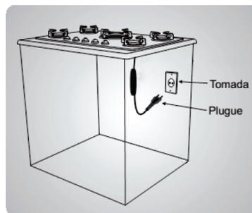
O aparelho deve ser instalado em uma rede com dispositivo de corrente residual (RCD) com uma taxa de corrente não superior a 30 mA.
