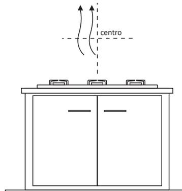
No modo depurador é necessário deixar uma abertura no móvel para saída do ar depurador (opção de saída frontal ou superior - do móvel).
